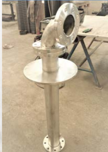
TETE DE FORAGE
